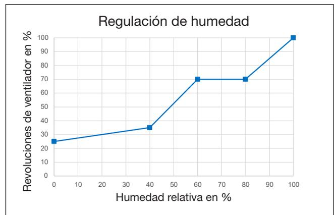
Diagrama: Línea característica ajuste de fábrica para modo de funcionamiento automático con regulación de humedad
