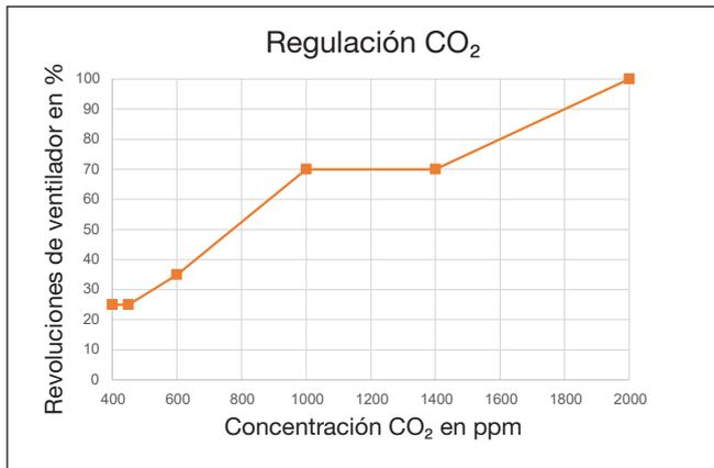
Diagrama: Línea característica ajuste de fábrica para modo de funcionamiento automático con regulación de CO<sub>2</sub>
