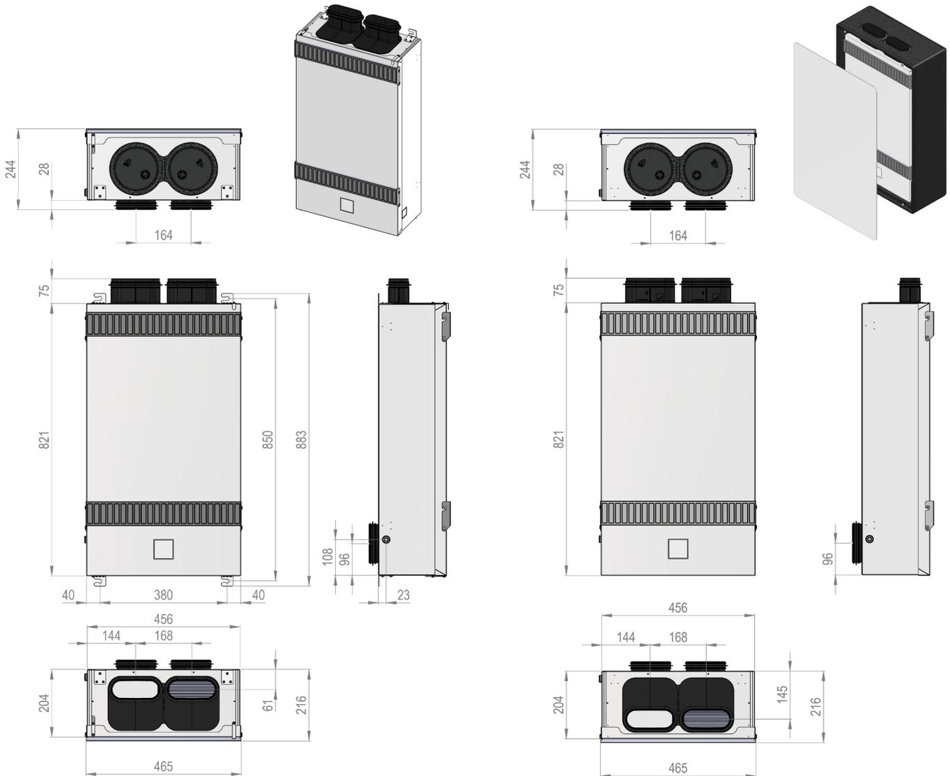
2.3.4 Disposición de las conexiones de aire
